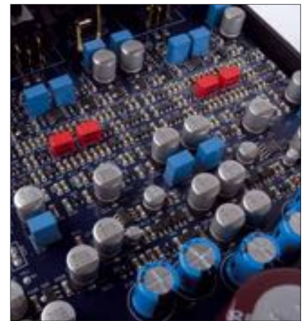
Auch die analoge Ausgangsstufe ist vollkommen symmetrisch aufgebaut
