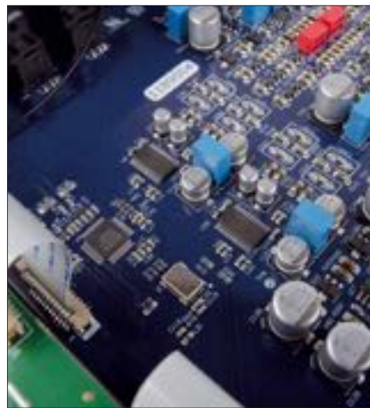
Die beiden Cirrus-Logic-Wandler nehmen sich jeweils einen Kanal vor, bei dem alle Signale mit 192 kHz bei 24 Bit verarbeitet werden
