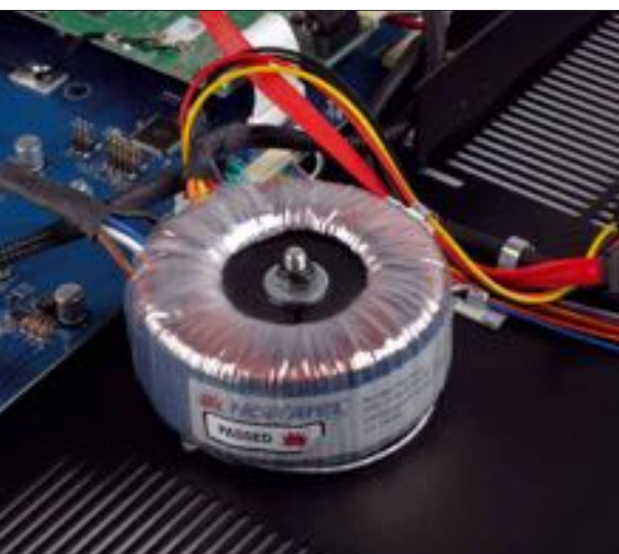
Ein großer Ringkerntrafo versorgt die einzelnen Sektionen des Gerätes mit Strom
