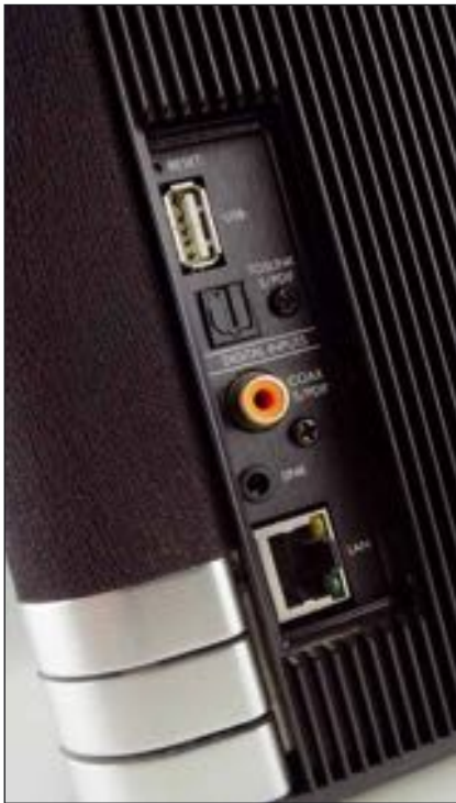
Neben Ethernet und WLAN dienen auch Toslink, koaxialer S/PDIF und BSB der Datenübertragung an den Tana SL-1
