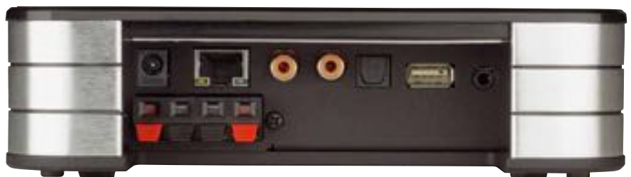
Einzige lose Kabellitzen finden an den Lautsprecherklemmen Platz, eine andere Lösung wäre bei einem so kleinen System allerdings auch schwierig geworden
