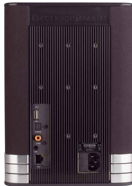
Die Class-AB-Endstufen der Tanas benötigen recht große Kühlkörper, die aber im Betrieb nur minimal wärmer werden
