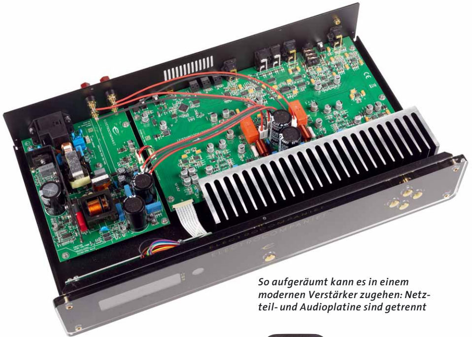
Die Leistungsverstärkung erfolgt in klassischer AB-Technik – die entsprechenden Transistoren sitzen in Reih und Glied auf dem Kühlkörper
