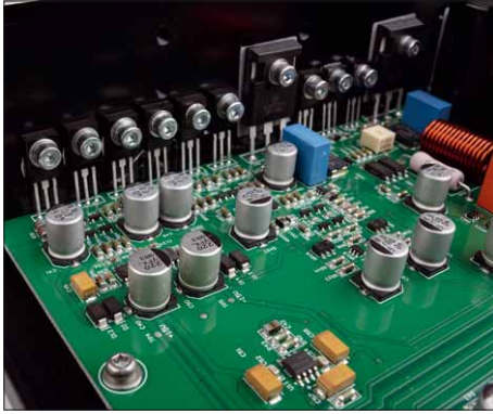
Die Leistungsverstärkung erfolgt in klassischer AB-Technik – die entsprechenden Transistoren sitzen in Reih und Glied auf dem Kühlkörper
