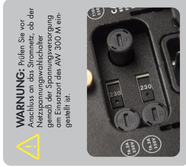
**WARNING:** Prüfen Sie vor Anschluss an das Stromnetz, ob der Netzspannungswahlschalter gemäß der Spannungsvorgang am Einsatzort des AW 300 M eingestellt ist.
