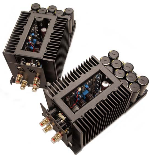
Die beiden Verstärkerzüge der Electrocompaniet AW 800 M
