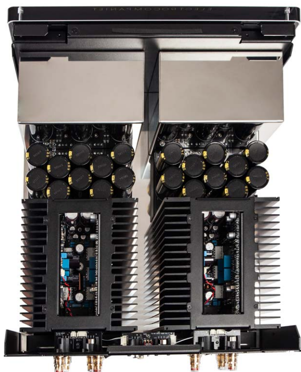
In der Endstufe Electrocompaniet AW 800 M arbeiten zwei getrennte Verstärker unter einem Dach
