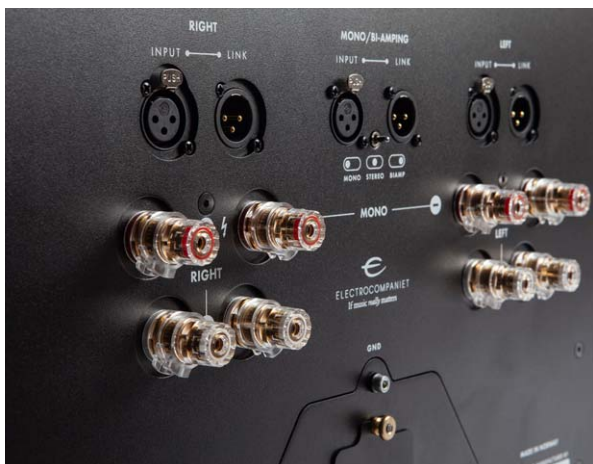
Das Anschlussfeld der Electrocompaniet AW 800 M wirkt etwas komplexer als gewohnt, was an der Flexibilität der Endstufe liegt. Neben Mono- und Stereobetrieb ist auch Bi-Amping möglich
