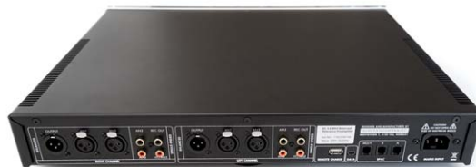
Das Anschlussfeld der Electrocompaniet EC 4.8 MkII: zwei symmetrische Eingänge und drei unsymmetrische, ein symmetrischer Pre-Out und ein unsymmetrischer Rec-Out. Das war's an Audioschnittstellen
